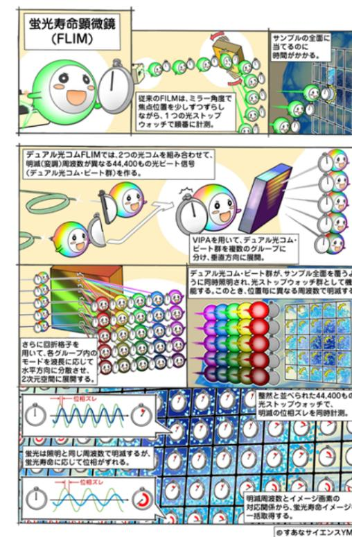
開発した蛍光寿命顕微鏡の仕組みの概念図。図中「FLIM」は蛍光寿命顕微鏡 (Fluorescence Lifetime Imaging Microscopy)、 「VIPA」は Virtually imaged phased array の略。
